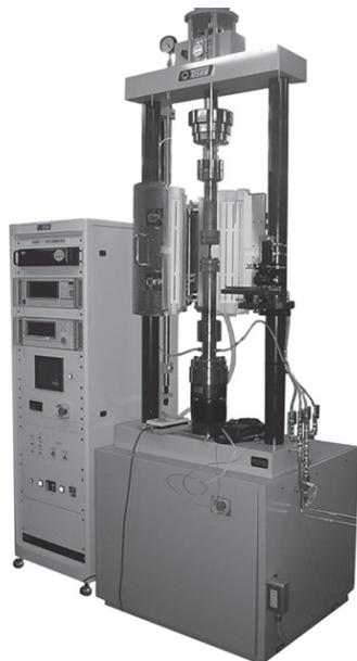
火力、原子力発電プラントの熱交換器、圧力容器などの高温機器の構造部材には、起動・停止や出力変動時の過度的温度変化に伴い、熱応力が発生し、この熱応力の変化により疲労とクリープを生じます。これらのクリープ疲れ特性を得るための試験装置で、高温機器構造材の寿命を予測することができます。
